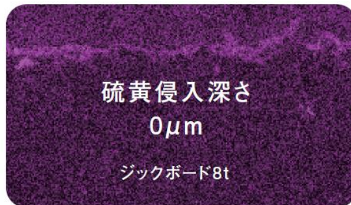
施工後14年経過したジックボード及びジョイント材採取サンプルの電子顕微鏡写真
