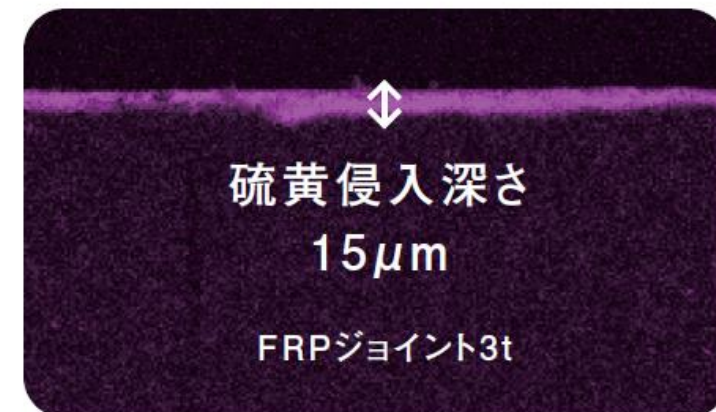
施工後14年経過したジックボード及びジョイント材採取サンプルの電子顕微鏡写真
