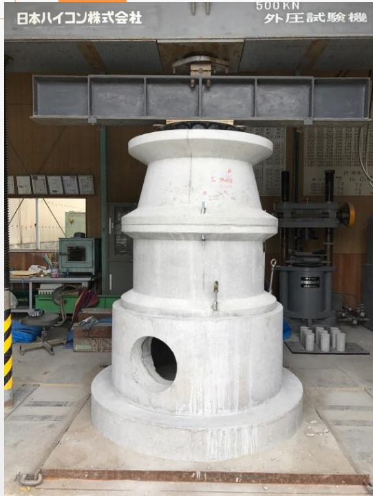
軸方向耐圧試験
