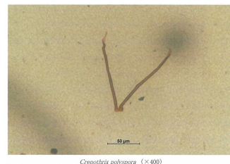
図-9 鉄バクテリア写真 (A市既設浄水場配水池)
