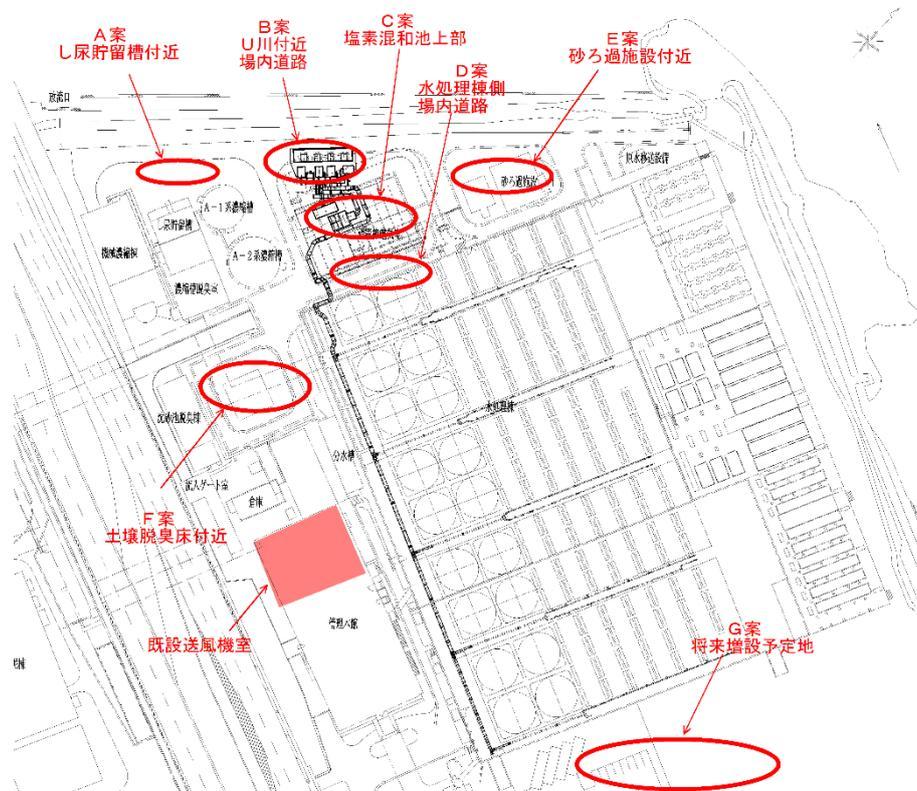
図-4 (送風機設置箇所図)
