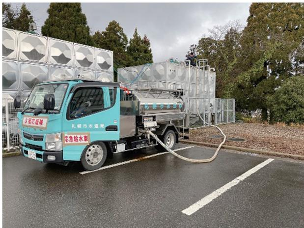
写真-1 受水槽への給水状況
