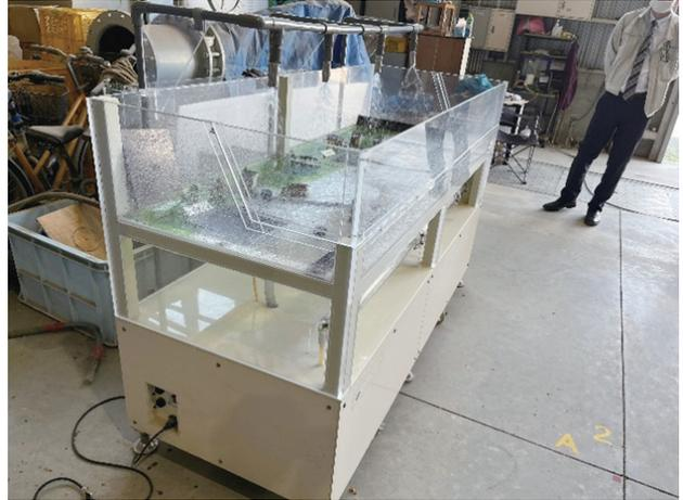
写真-6 雨水排水 卓上水理模型
