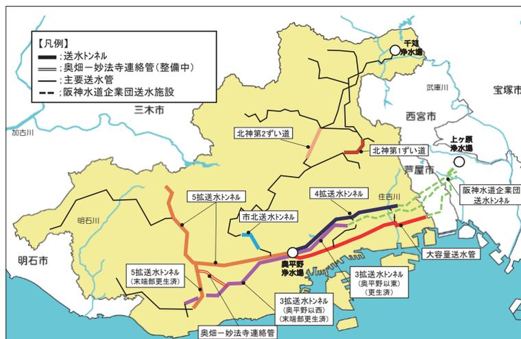
図－3 神戸水道送水幹線の概況
