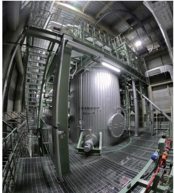
写真-4 改築した1号汚泥焼却炉
