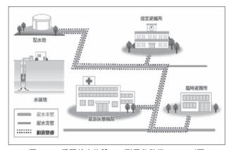
図-6 重要給水施設への耐震化整備イメージ図
