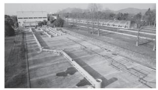
写真-1 国総研内に整備した下水道管路模擬施設
