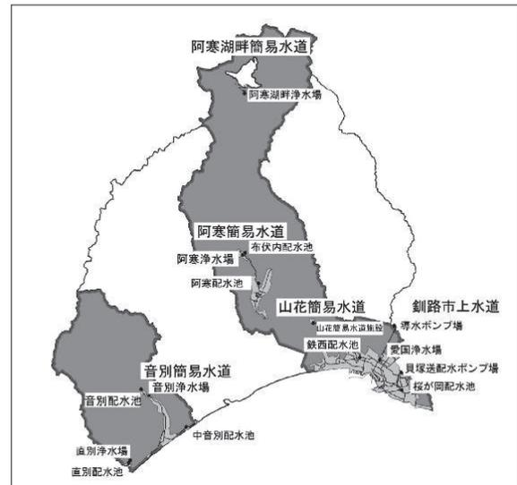
図－2 釧路市の水道施設配置状況
