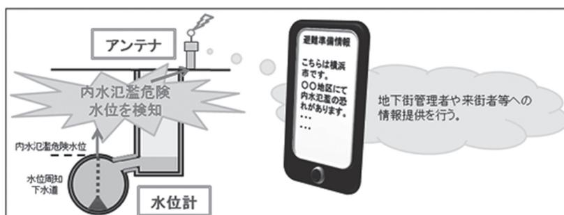
水位周知下水道の概要図
