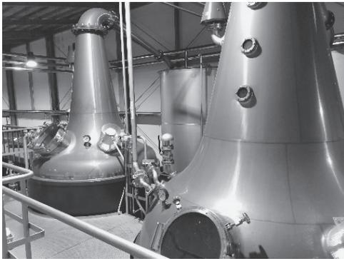
写真-4 蒸留釜(ポットスチル)
