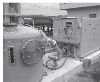
「モバイルシフォンタンク」は日量 12 m<sup>3</sup> から最大 900 m<sup>3</sup> まで。処理量に合わせ全 9 ラインナップから選べます
