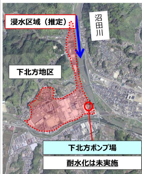
今回の豪雨において河川氾濫によりポンプ場が浸水し機能停止した事例。 (広島県三原市)
