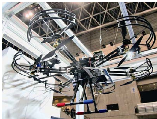
橋梁等の打音検査ドローン （NEC）
