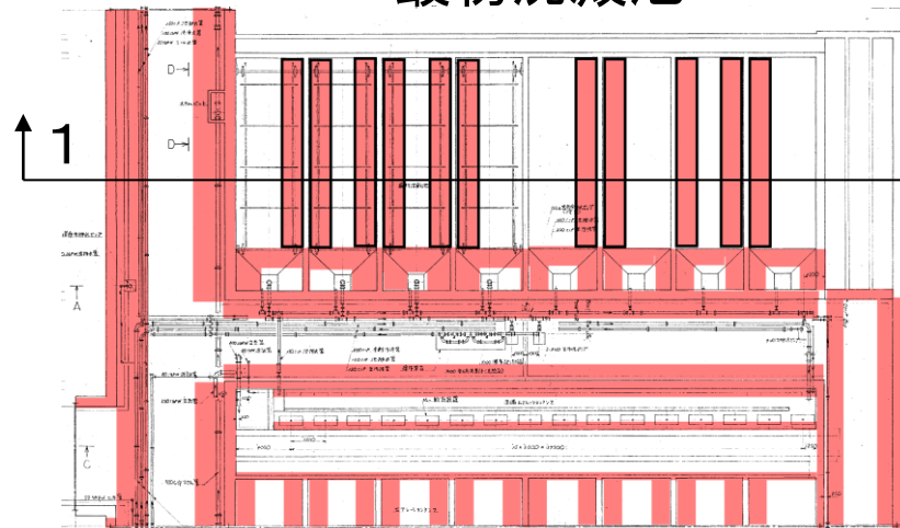
最初沈殿池 補強範囲平面図
