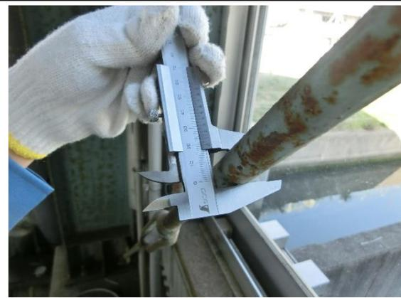
既設ブレース部材寸法測定
