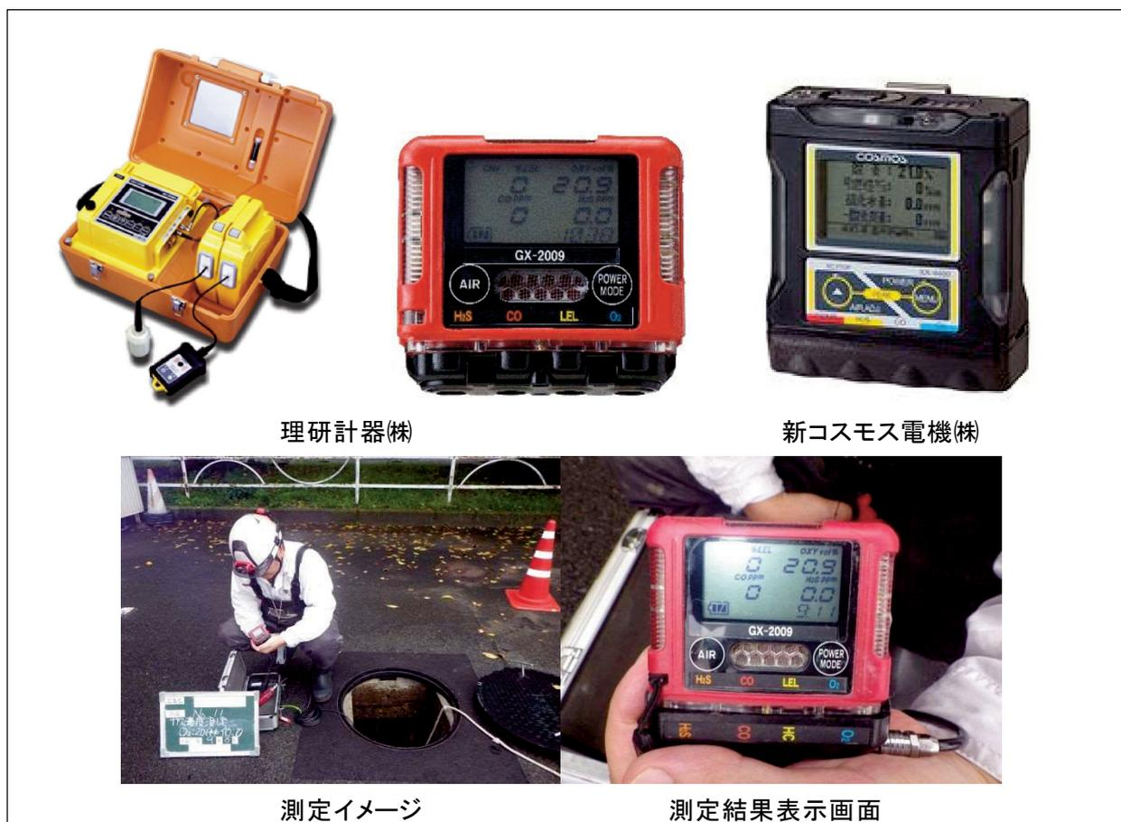
図 5.3.2 ガス検知器の例と測定例
