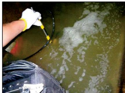
写 2.1.11 電磁流速計による流速測定
