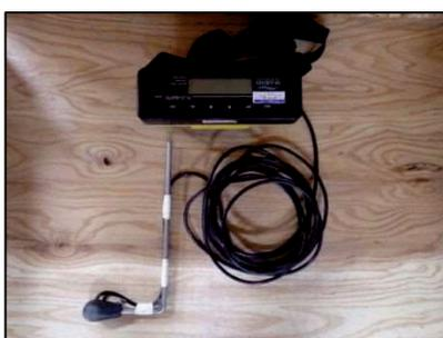
写 2.1.4 電磁式流速計
