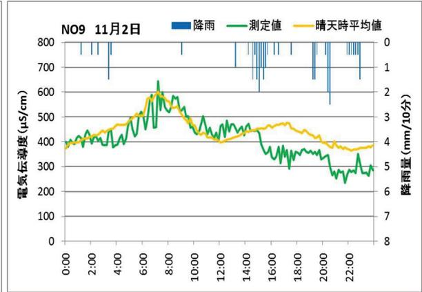
図 4.4.4 雨天時浸入水の疑いがない箇所
